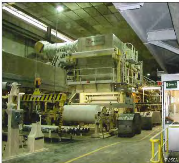
L'usine SCA à Stembert fabrique du papier de base qui est ensuite traité dans deux unités. En photo : la machine à papier n°1, un modèle Beloit single wire.
